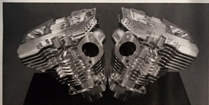
Ovan: Billett-topparna finns både för enkel och dubbla förgasare. Nedan: Ken Nagai på Ken's Factory i Los Angeles har hjälpt kanadensarna bygga en showbike med deras motordelar som rullande reklampelare.
