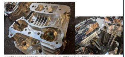
もはや芸術的できえある切削痕も美しいアルミビレットヘッド。高精度な加工により理想的なトルクパワーカーブを実現しており、船動からレッドラインまで力強く固るようになる他、エンジン男命や概費の向上も期待できる。 The machining marks left on these aluminum heads are beautiful, even artistict. Their high-precision machining allows you to achieve an ideal torque-power curve. In addition to making the engine run powerfully from start-up to red-lining, they will also increase its lifespan and fuel efficiency.
